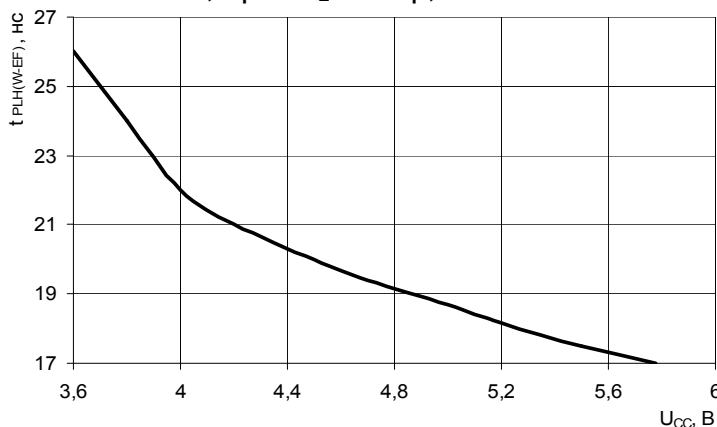
Рисунок 37. Зависимость времени задержки распространения сигнала выключения флага FF от напряжения питания, при: C_L=30 пФ, T=125 °С
