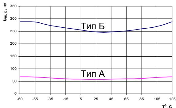
**Рис. 8** Зависимость времени задержки распространения передатчика при выключении  $t_{DPHL\_D}$  и времени задержки распространения передатчика при выключении  $t_{PHL\_D}$  от температуры, для микросхем.
