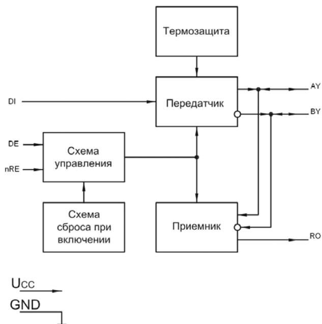
**Рис. 1** Структурная блок-схема
