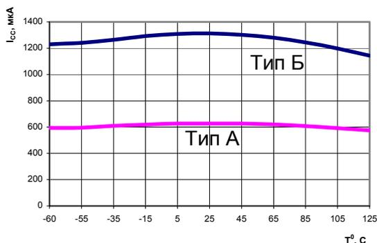
**Рис. 3** Зависимость тока потребления от температуры для микросхем при: DE= U<sub>CC</sub>.
