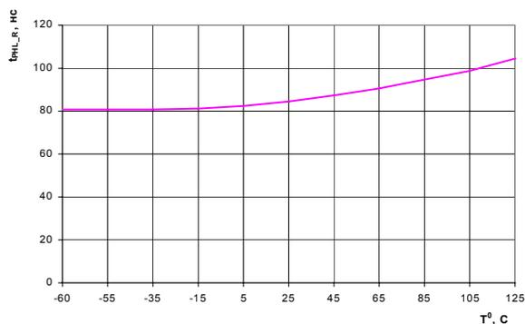
**Рис. 11** Зависимость времени задержки распространения приемника при включении  $t_{PHL\_R}$  от температуры для микросхем.
