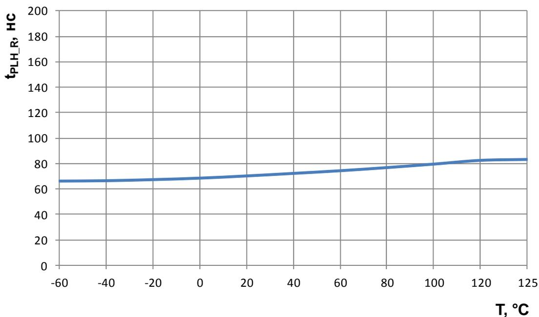
Рисунок 10 – Зависимость времени задержки распространения сигнала приемника при выключении  $t_{PHL\_R}$  от температуры при  $U_{CC} = 4,5$  В
