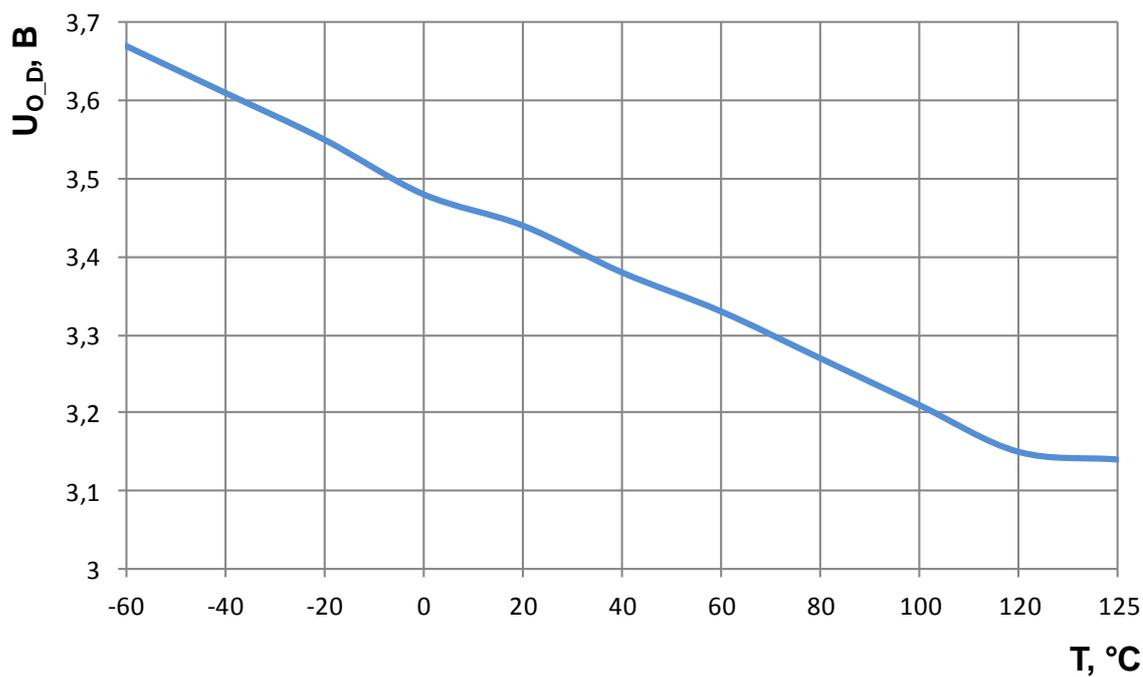
Рисунок 7 – Зависимость выходного дифференциального напряжения передатчика U<sub>o\_D</sub> от температуры при U<sub>CC</sub> = 4,5 В
