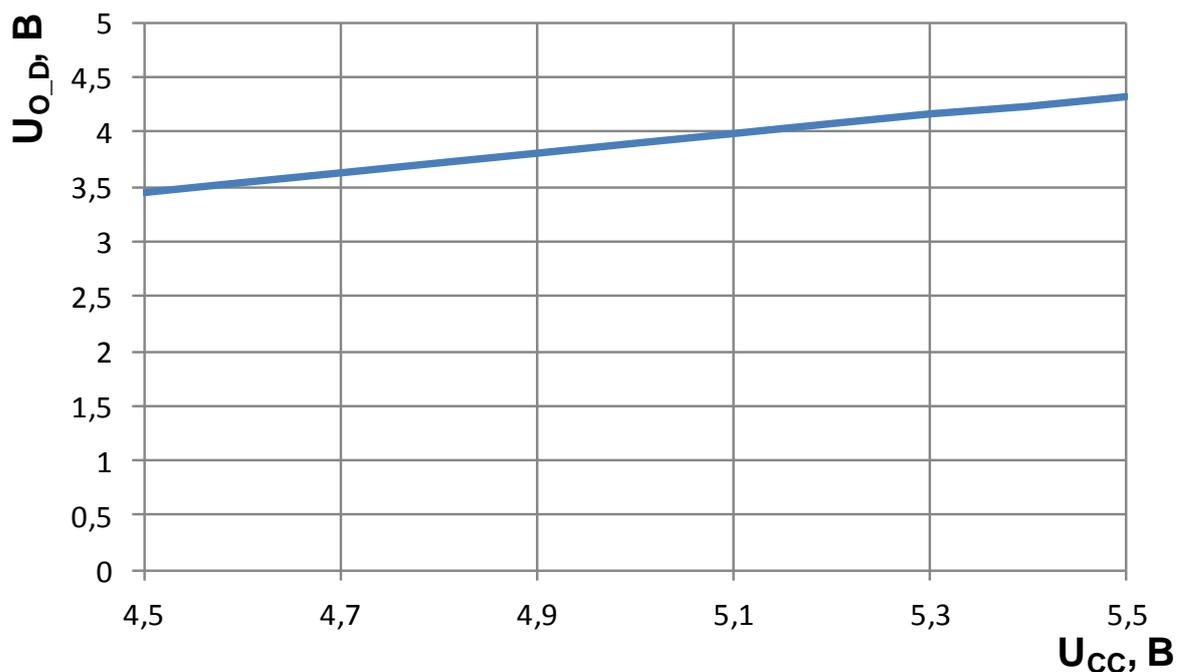
Рисунок 6 – Зависимость выходного дифференциального напряжения передатчика U<sub>o\_D</sub> от напряжения источника питания при T=25 °C
