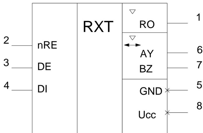
Рисунок 2 – Условное графическое обозначение
