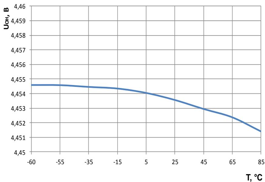
Рисунок 9 – Зависимость выходного напряжения высокого уровня от температуры при напряжении питания 4,5 В, I<sub>ОН</sub> = 1 мА
