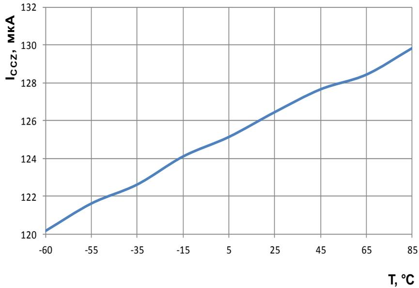
Рисунок 6 – Зависимость тока потребления в состоянии «Выключено» от температуры при напряжении питания 4,5 В
