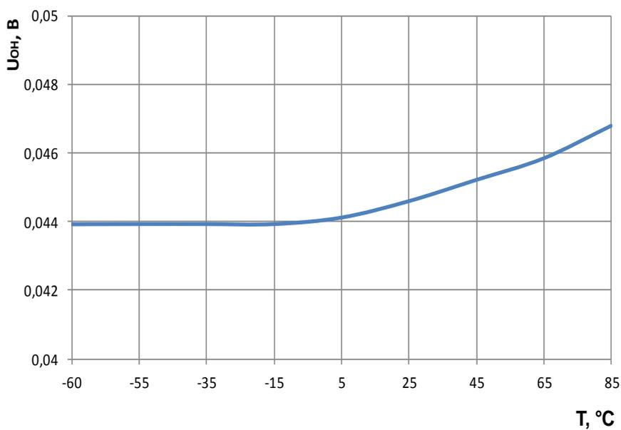
Рисунок 10 – Зависимость выходного напряжения низкого уровня от температуры при напряжении питания 4,5 В, I<sub>ОЛ</sub> = 1 мА
