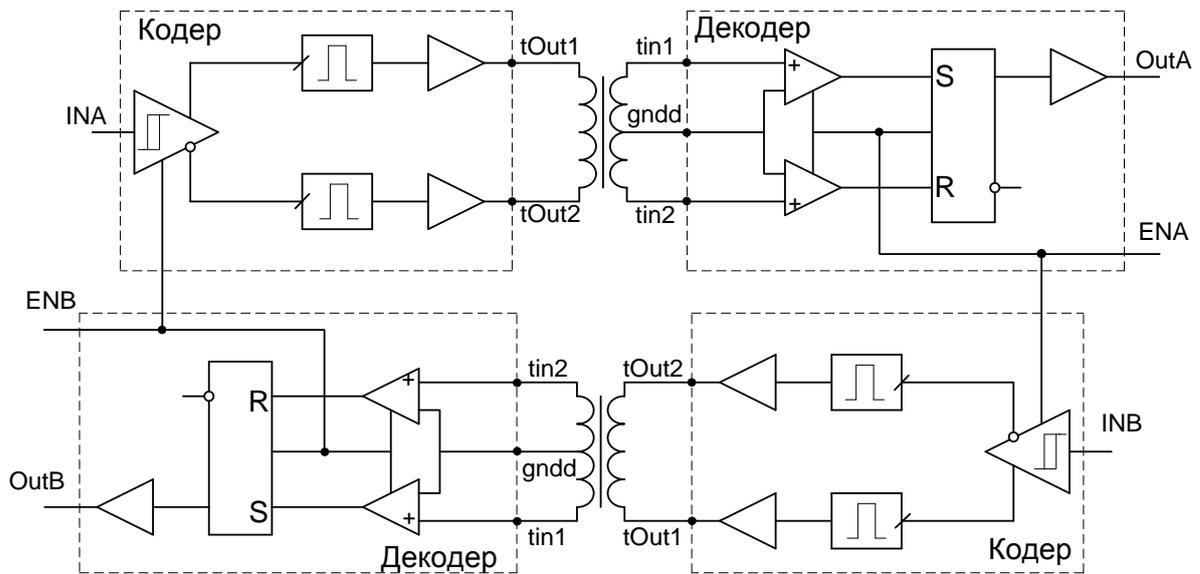
Рисунок 3 – Функциональная схема приемопередатчика с импульсным трансформатором
